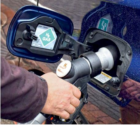
Dans le cadre du projet Hyway, piloté par Tenerdis, soutenu et cofinancé par l'ADEME et la Région Auvergne-Rhône-Alpes, des entreprises et des collectivités utilisent une cinquantaine de Renault Kangoo électriques hydrogène, équipées d'un prolongateur d'autonomie Symbio. À Grenoble, un électrolyseur produisant de l'H2 décarboné issu d'électricité renouvelable alimente la station. Un projet
